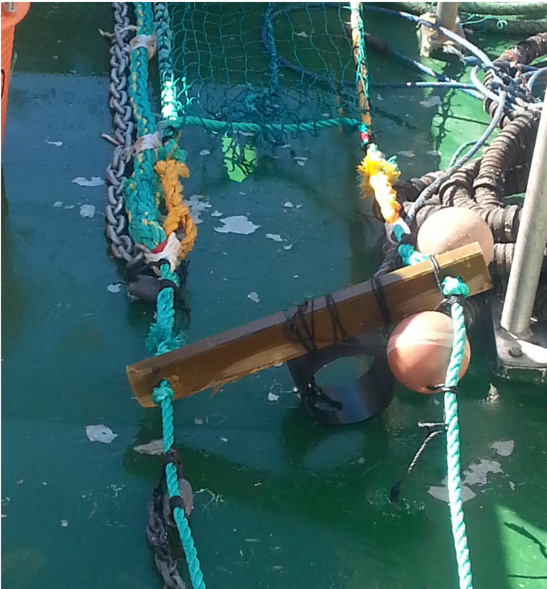
Figur 10: På vingeendene brukte vi bøtre av tre.
